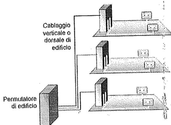
Il cablaggio di dorsale di edificio si estende dal locale tecnico/armadio principale di edificio (Centro stella) agli armadi di piano, in alternativa si potrà prevedere di estendere delle dorsali fra i vari armadi di piano previsti nel progetto. Il sottosistema così rappresentato include i cavi di dorsale dell'edificio e le relative terminazioni a pannello di permutazione.
